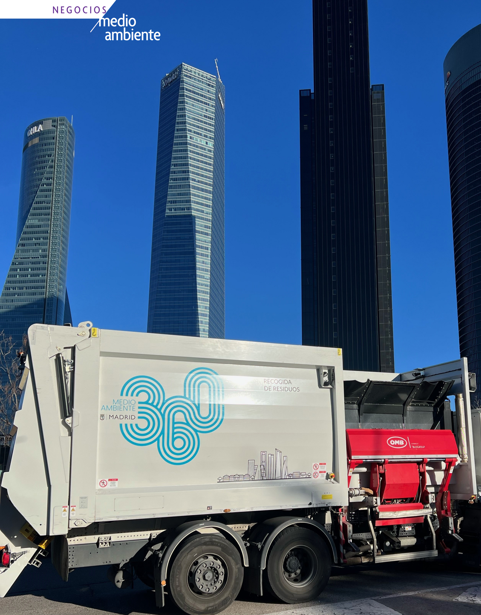
Camión recolector de basuras de carga lateral de Gas natural comprimido (GNC)
